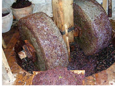
Zeytinlerin Hamur Haline Getirilmesi
