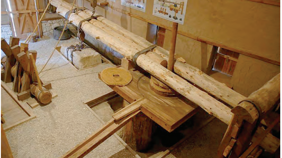
Baskı Sistemi (Bocurgat, pres tablası, pres kolu)
