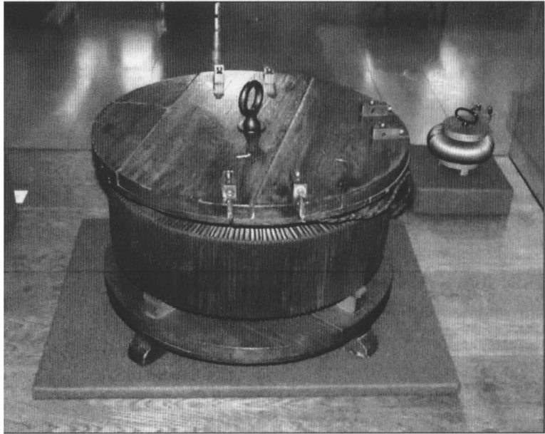
ŞEKİL 3.1. Zipernowsky, Bláthy ve Déri'nin 1884 ila 1885'te geliştirdiği ilk transformatörler, Budapeşte'deki Uygulamalı Sanatlar Müzesi'nde bulunuyor.
