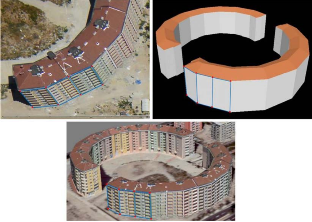
Eğik hava fotoğrafı, katı model ve kaplanmış 3B bina modeli
