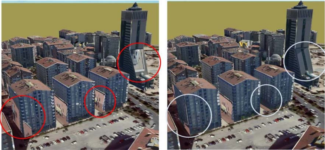
Otomatik kaplamada görünürlük analizinin etkisi
