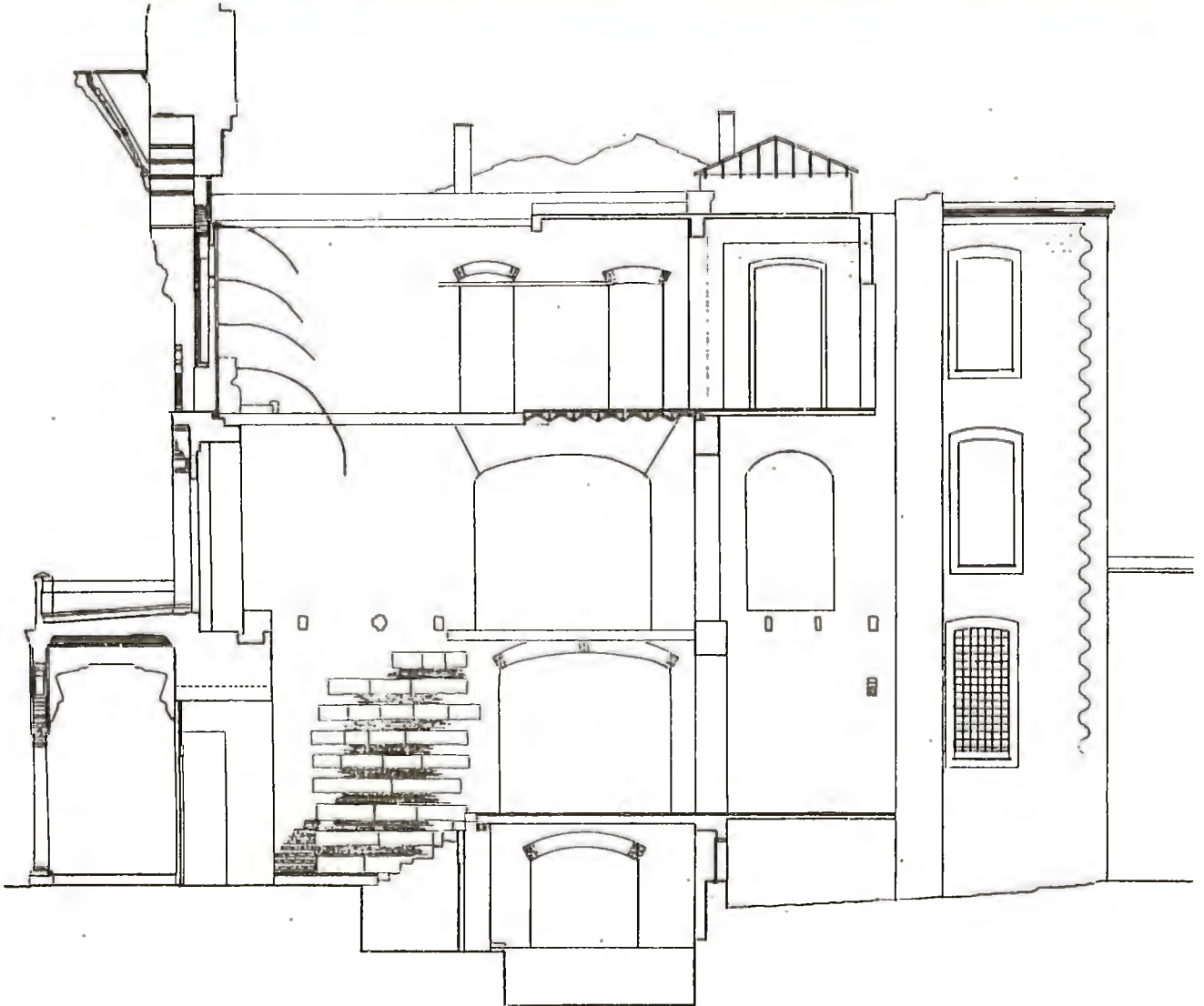
12. Ana bina geniş holünden geçen kesit: doğu duvarında sıva altından çıkan almalı örgü 1. kata kadar yükselmektedir.
