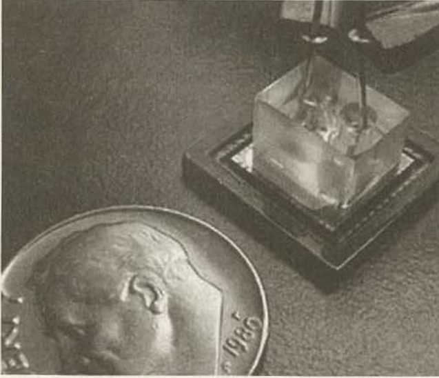
Çip üzerindeki mikroskop: yarı iletken çip üzerine uyumlu 10 sent'ten daha küçük yeni bir mikroskop. Elektrodlar sıvının transparan bir kanaldan akışını kontrol eder. Işık, çipe gelen ışık demetini kaplayan metal bir katmana açılan bir dizi deliğe kanal vasıtasıyla ulaşır. Sıvıdaki objeler ışığın deliklerden geçişini engeller bu da imajı meydana getirir.
