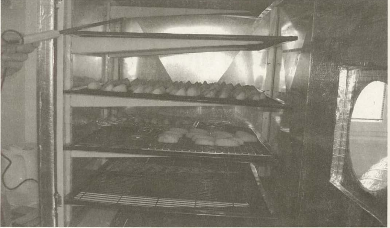
Şekil 6 Elmaların kurutma kabinine yerleştirilmesi.
