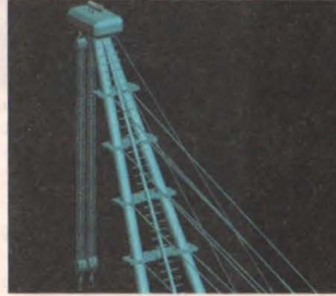
[M7] Modelde vinç kolunun baş kısmı görülmektedir. Bakım ve onarım için kullanılan merdiven hiç te alışagelmiş bir çözüm olmamasına karşın son derece işlevseldir ve tepe noktasındaki başlığa kadar uzanır.
