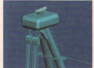
[M8] Başlık sistemi ve güç kablolarının başlığın içine girdikten sonra farklı bir pozisyonda nasıl dışarı çıkarak kaldırıcı makara sistemine güç aktardığı modelde görülmektedir. 19. yüzyıl ortalarına doğru başlığın tepesine bir gemi modeli de yerleştirilmiştir. Dönem resimlerinin incelenmesi bu modelin boyunca 2 m civarında olduğunu düşündürmektedir.
