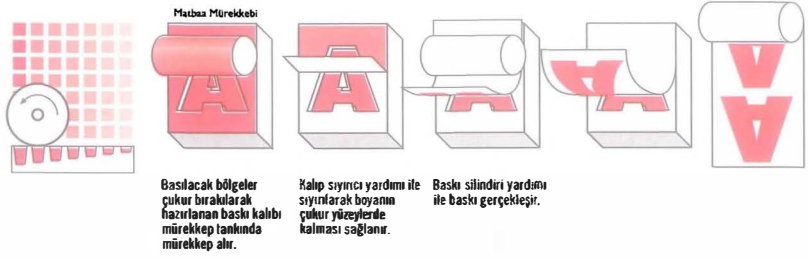
Şekil 4.21 Tifdruk baskı aşamaları.
