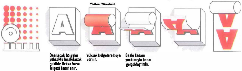
Şekil 4.19 Flekso baskı tekniği
