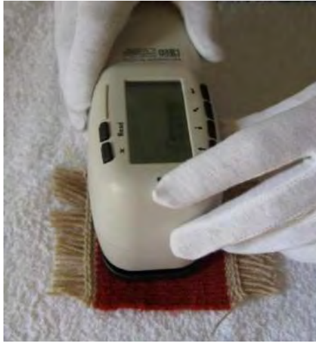
Resim 3. Spektrofotometre (Renk Ölçüm Cihazı), Tekstil Koruma ve Onarım Laboratuvarı
