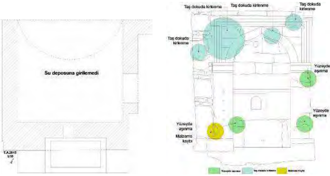
Çizim 11-12: Celeb Çeşmesi. Plan ve cephedeki bozulmalar.
