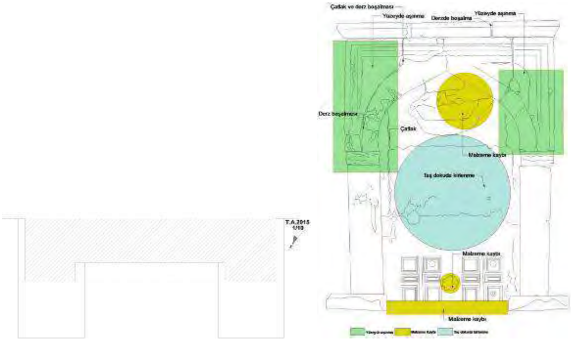
Çizim 19-20: Gediz Uluyolu Çeşmesi. Plan ve cephedeki bozulmalar.
