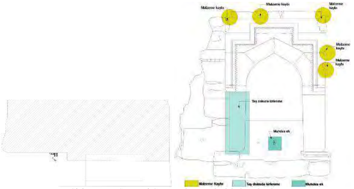
Çizim 33-34: Sünnetçi Çeşme. Plan. Cephedeki bozulmalar.
