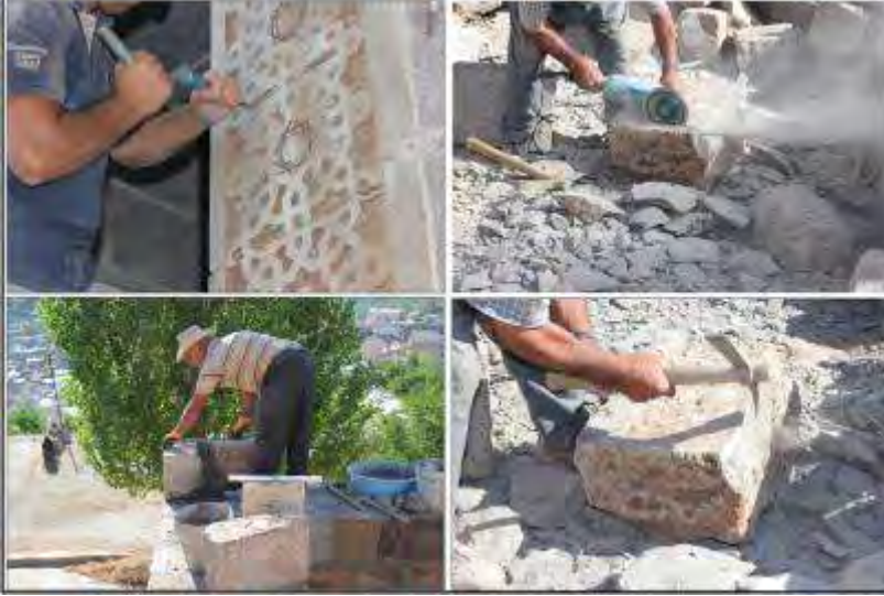
Foto 1. Taş Ustalığında Saplı, Sapsız ve Elektrikli Aletler Kullanılmaktadır.
