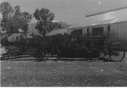
Toprakkale-Erzurum yol inşasında kullanılacak Amerikan grayderleri National Archives
