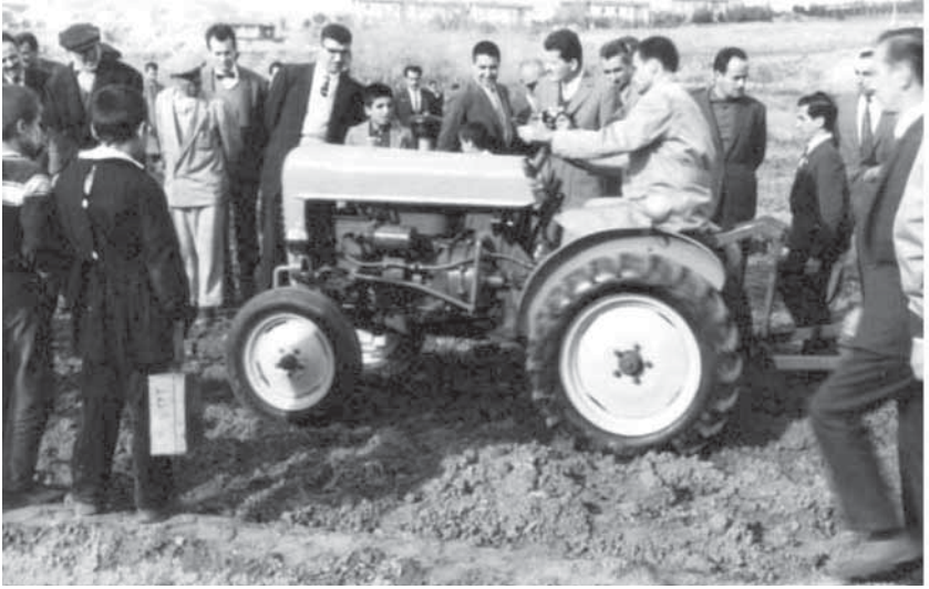
Traktör bir gövdeli pulluk çekebilecek şekilde tasarlanmıştır.
