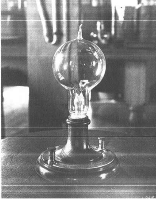
Edison'un ampülü, önceki modellerde daha düşük akım elektriği, küçük bir karbonize kaplama ve ampul içinde gelişmiş bir vakum kullanan önemli bir gelişmeydi. Bu Edison'un 1879'da tamamladığı başarılı akkor lambasının bir kopyasıdır. ABD İçişleri Bakanlığı, Milli Park Servisi, Edison Ulusal Tarihi Bölgesi.
