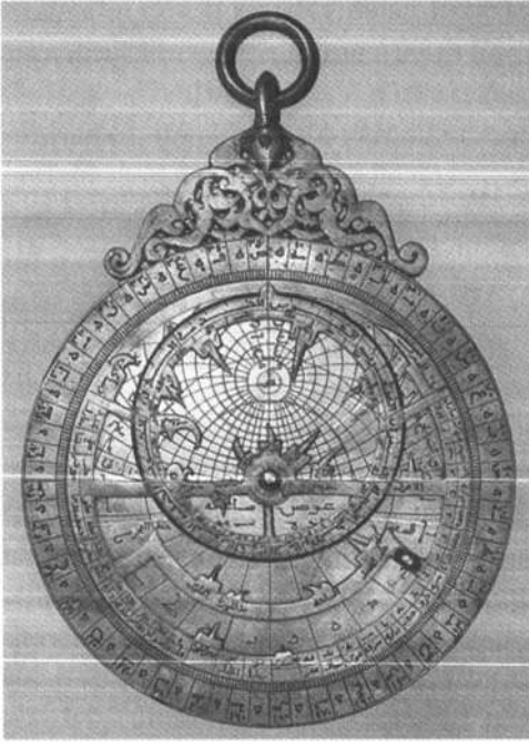
Gezegenlerin hareketlerini incelemek ve burçları hesaplamak için kullanılan bir Yemen usturlabı. Daha küçük dairenin üstündeki işaretçi güneşle hizalandığında, alet enlemi ölçer ve böylece günün saatini hesaplar. Metropolitan Sanat Müzesi.
