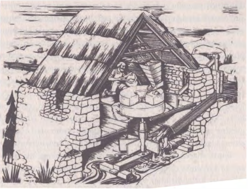
Şekil 16.3. Yatay su değirmeni. Bu nispeten hesaplı ilkel değirmenlerin dişli takımı yoktu ve oldukça az suyla çalışıyordu. (Terry S. Reynolds, Stronger than a Hundred Men . Copyright 2002, John Hopkins University Press’in izniyle)
