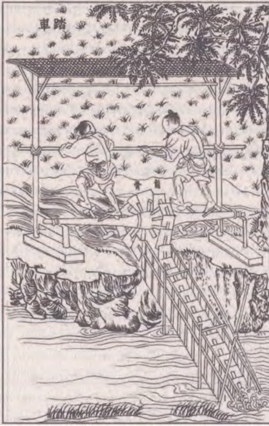
Şekil 12.4. Zincirli tulumba. (Joseph Needham'ın Science and Civilization in China kitabından, cilt 7, s. 309. Cambridge University Press'in izniyle.)
