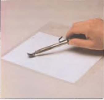
1 Yapıştırıcı tabakayı birkaç noktada tutturun. Bunun için bir ütünün ucunu da kullanabilirsiniz.
