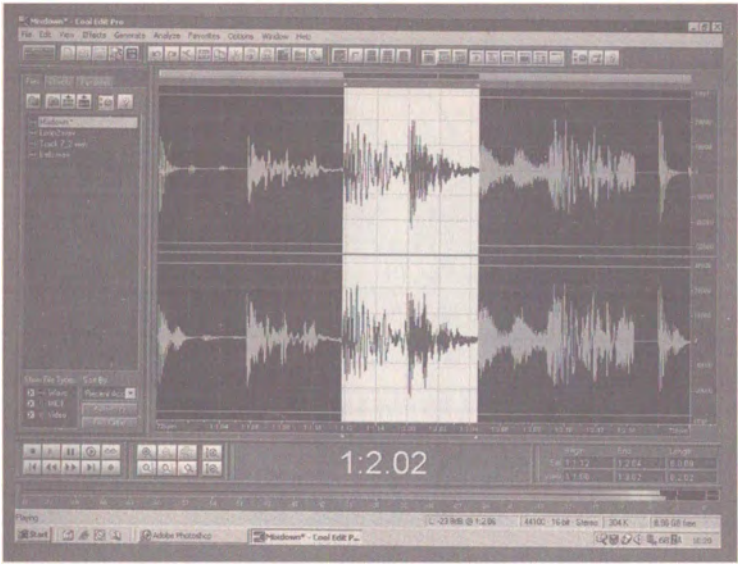
Şekil 25. Bir sayısal ses kurgulayıcısının ekran üzerindeki görünümü; Sağ ve sol kanal ses dalga şekli, araç çubuğu, zaman göstergesi, seviye göstergesi, ses dalgasının seçili bölgesi, sesleri ileri ve geri kaydırma, zoom yapma, kesme-yapıştırma, gibi diğer kurgu araçları (Middleton, 2003, s.35).
