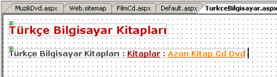
Şekil 10. PathDirection özelliği CurrentToRoot yapıldığında.
