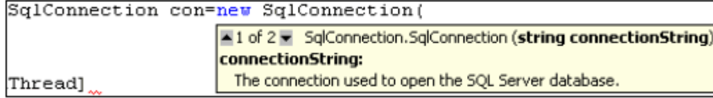
Şekil 2. Örnek bir Overload Constructor(Aşırı Yüklenmiş Yapıcı) metod.
