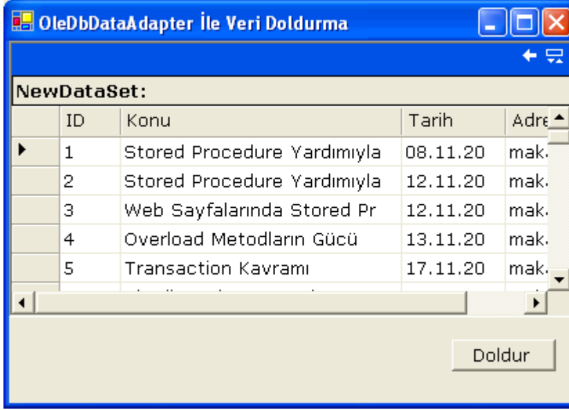
Şekil 3. Fill Metodu ile DataSet'in doldurulması.
