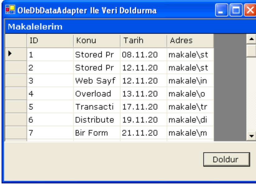
Şekil 9. Fill metodu ile verilerin DataTable'a aktarılması.
