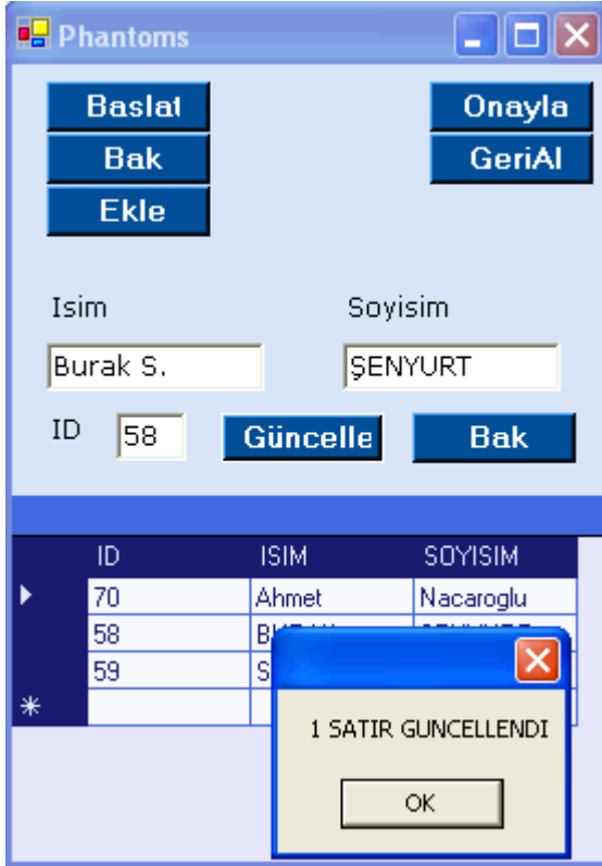
Şekil 5. Transaction2' de Transaction1' de aynen görünen satırlardan birisinde güncelleme yapıldı.
