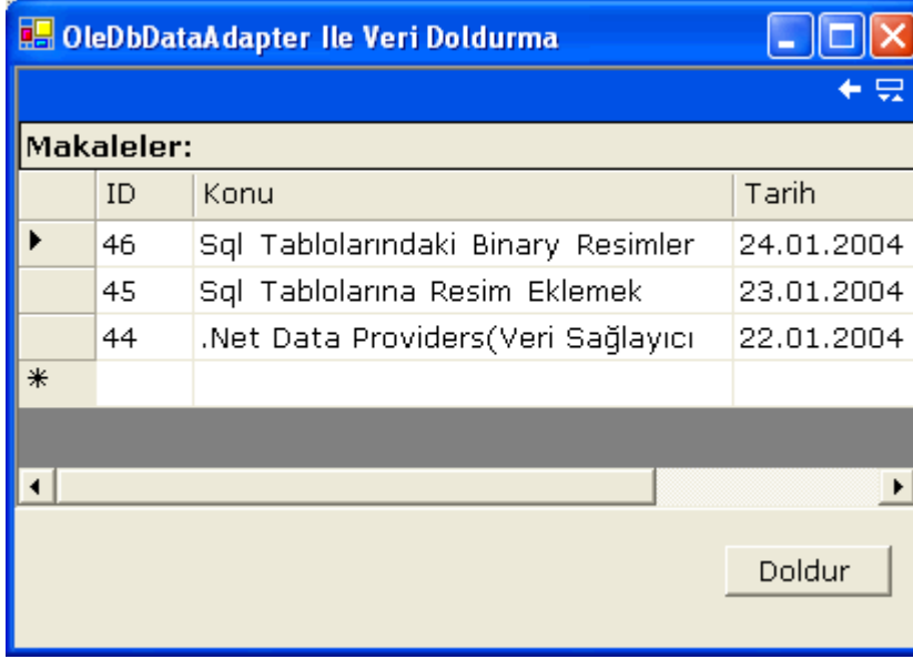
Şekil 11. Fill metodu ile belli bir satırdan itibaren belli sayıda satır almak.
