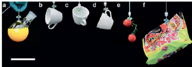
Geko'dan esinlenerek geliştirilen çok amaçlı tutucular: A) 200 ml sıvı ile dolu cam şişe (toplam ağırlığı 307 gr), B-D) 118 gr kahve fincanı, E) 41 gr küçük domates, F) 139 gr plastik torba
