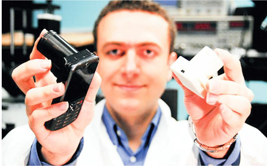
Aydoğın ve ekibinin geliştirdiği iki önemli cihaz: Soldaki holografik mikroskop, sağdaki ise mercekless mikroskop
