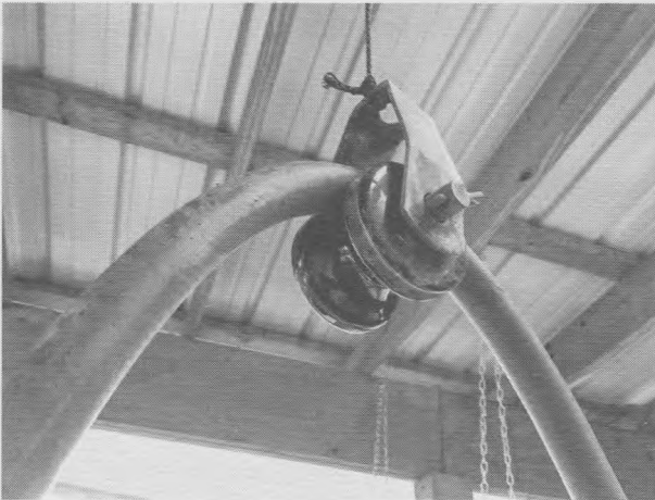
İmalathanede ve seralarda hortumları asmak için yeniden değerlendirilmiş elektrik izolatörlerini kullanıyoruz.
