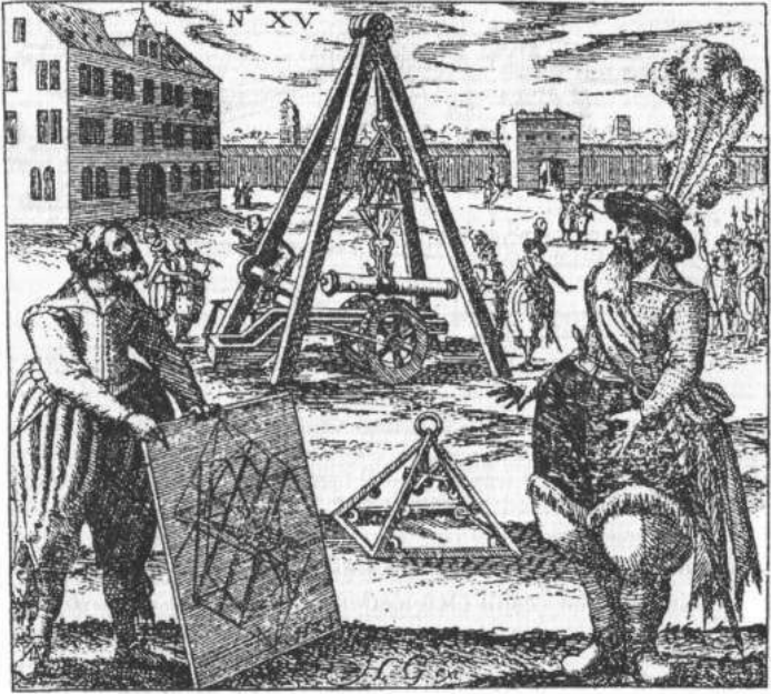
Şekil 76. Topu kaldıracak vinç düzeneği üzerinde çalışan geometrici ve savaş mühendisi [Heinrich Zeising (16./17. yüzyıl), Theatrum machinarum (Makineler Sahnesi), Leipzig, 1607]. 11
