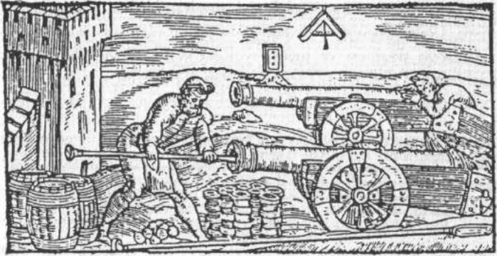
Şekil 77. Topun doldurulması ve namlu ayarı: Görüldüğü üzere arkadaki topçu, göz yardımıyla namlu ayarı yapmaktadır (V. Biringuccio, De la pirotechnia , Venedik, 1540). 101
