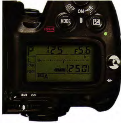
Fig. 7.3: Örtücü hızının LCD panelden kontrolü.
