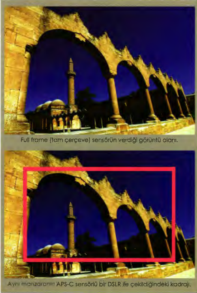
Fig. 31.2: APS-C sensörlü DSLR fotoğraf makinelerinin sensör alanı filminden daha küçük olduğu için görüntü alanı daralmıştır. Çözümü aynı kadrajı (üstteki) alabilmek için ya daha geriye gitmek ya da daha geniş açı bir objektifle çekimi gerçekleştirmektir.
