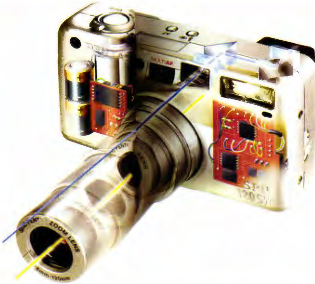
Fig. 2.5: Dijital kompakt fotoğraf makineleri ile optik vizör kullanılarak yapılan çekimlerde paralaks hatası oluşur.
