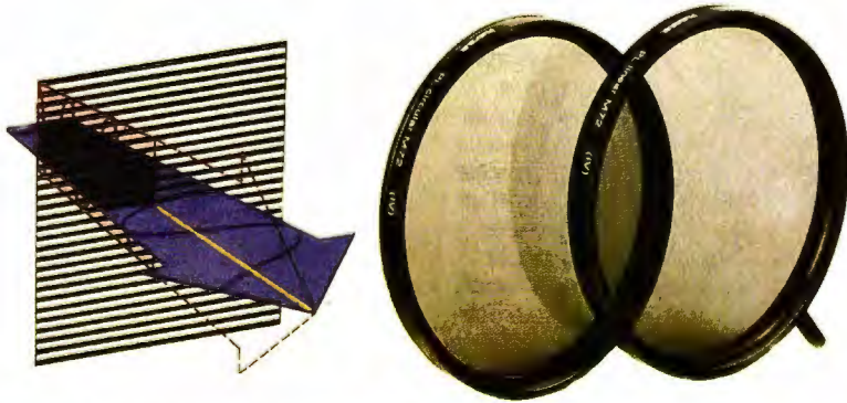
Fig. 27.6: Konudan yansıyan ışınların polarize olması ve filtre yardımıyla polarize olmuş ışınların tekrar paralel demetler haline getirilişi.
