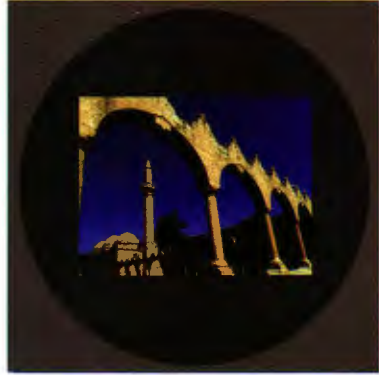
Fig. 31.5: Solda bir 35 mm film kullanan fotoğraf makinesi için tasarlanmış bir optiğin net görüntü dairesi çapının filmle olan ilişkisi, sağdaysa aynı optiğin çarpanı 1,5 olan ve boyutu filmde daha küçük olan bir DSLR'de kullanıldığında sensörle arasındaki ilişkisi gözükmetedir.
