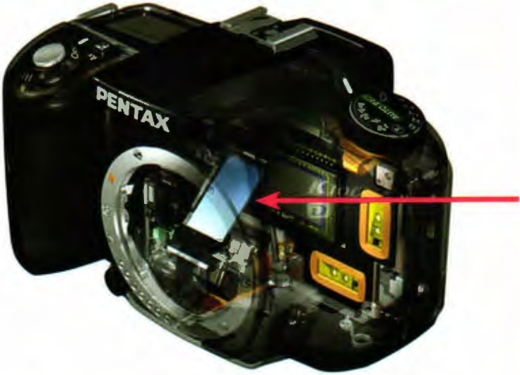
Fig. 7.6: DSLR'lerde perde örtücü 45 derecelik aynayla sensör arasındadır.
