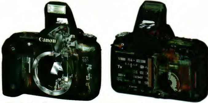
Fig. 1.10: Bir DSLR fotoğraf makinesinin iç yapısının önden ve arkadan görünüşü.
