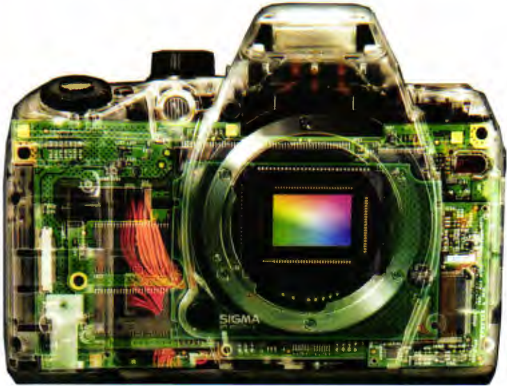
Fig. 1.11: Bir DSLR fotoğraf makinesinin iç yapısı.
