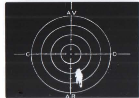
41. Kinetogram: Kinetometre'nin ölçtüğü denge değişimlerinin vektör grafiği.
