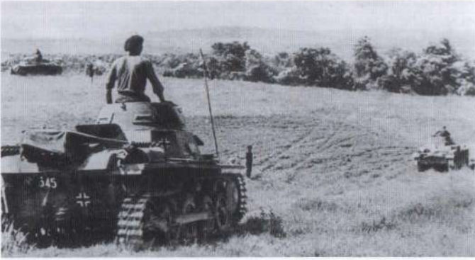
Fotoğrafta, arazide eğitim yapan bir Panzer alayı görülmüyor, 1939 yazı. Arkada Panzer I hafif tankı, önde 20mm'lik topla teçhiz edilmiş hafif Panzer II tankı görülmüyor. Solda, uzak noktada ise 37 mm'lik topuyla Panzer III ve kısa namlulu 75 mm'lik topuyla Panzer IV orta sınıf tanklar göre çarpıyor. (Özel koleksiyon)
