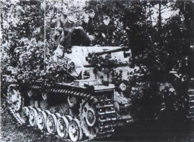
Kamufleajla gizlenmiş bir Artillerie Panzer Beobachtungswagen III. Topla teçhiz edilmiş bu zırhlı gözlem aracı Şubat 1943'te Panzer III temel alınarak geliştirilmişti. Zırhlı ve kundağı motorlu topçu birliklerinin kullanımına sunulan araç o tarihten itibaren Panzer tümenlerinin standart unsurlarından biri hâline geldi. (Carlo Pecchi)
