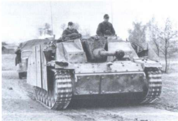
Bir Sturmgeschütz III Ausf. G taarruz topu, Doğu Cephesi. 75 mm'lik L/43 ya da L/48 model uzun namlulu topla teçhiz edilen StuG III 'lerin ilk varyantı Mart 1942'de üretilmeye başladı ancak yeni modelin seri üretimi ancak yılın sonunda başladı. 1945 yılının Mart ayına kadar toplamda 7.700 StuG III üretilmişti. (Özel Koleksiyon)
