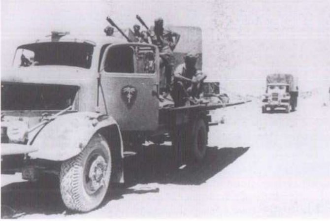
Rommel, Kuzey Afrika seferinin büyük bir kısmında doğaçlama yapmak ve düşmandan ele geçirilen teçhizatı kullanmak zorundaydı. Fotoğrafta, şasesinin üzerine 20mm'lik Flakvierling 38 model dört namlulu bir uçaksavar yerleştirilen bir Opel Blitz ve İngilizler'den ele geçirilen Ford kamyon görülmüyor. (Carlo Pecchi)
