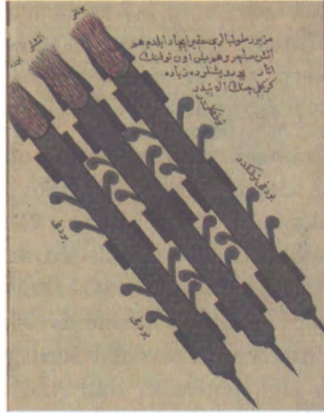
Görsel 6: Humbaracı ustası Ali Ağa'nın icat ettiği kenarlarına tüfekler eklenmiş ateş tulumbası. Bayramoğlu Ali Ağa, Ümmül-Gazâ , s. 124.
