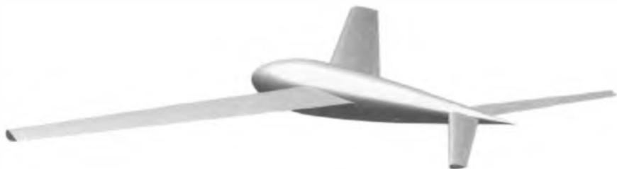
Şekil 18 Uçan araba seyir halinde. Yükseldiği zaman ayaklarını, direklerini ve yelkenlerini içeri çekecek. Şekildeki yapı, uzun ve ıleriyte yatık kanatlarıyla eksi direnç için uygun hale getirilmiştir.
