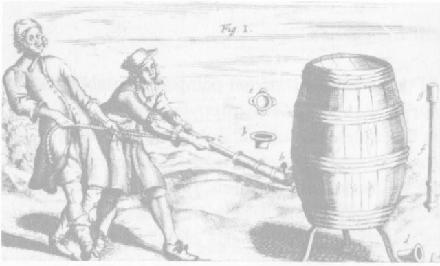
Şekil 88. Von Guericke'nin tahta bir ıçının içinde vakum oluşturma girişim. Experimenta Nova , Amsterdam, 1672.
