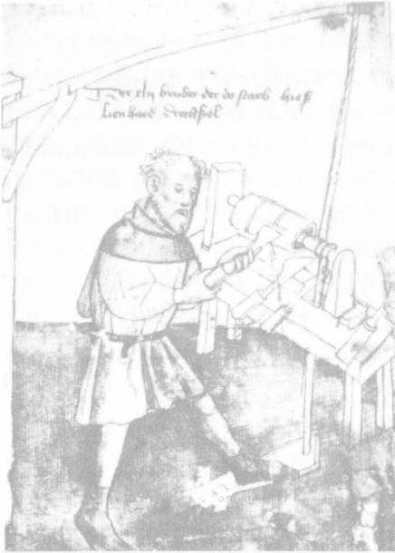
Şekil 32. Ayak pedalıyla çalıştırılan torna. Mendelschen Zwölf Bruderbuch'tan. 1395.
