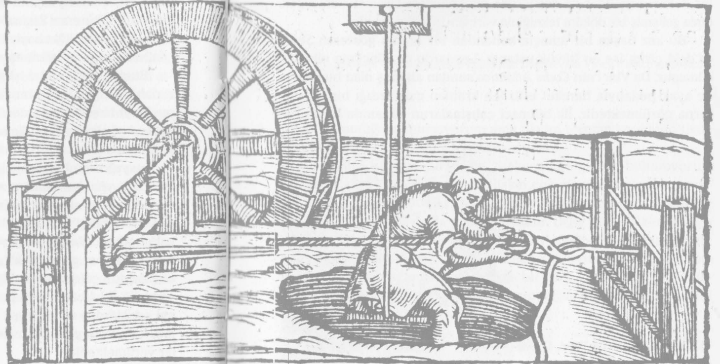
Şekil 43. Tel çekme makinesi. Biringuccio, De la Pirotechnia , 1540.
