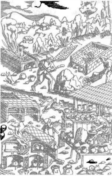
ŞEKİL 105. Ortaçağ'da bitüm ve kükürt eritme fırınları; sağ altta çömlekçi çarkında çalışan usta [Georgius Agricola (1494-1555), De re metallica libri XII (Madencilik Üzerine 12 Kitap), Basel, 1556]. 54
