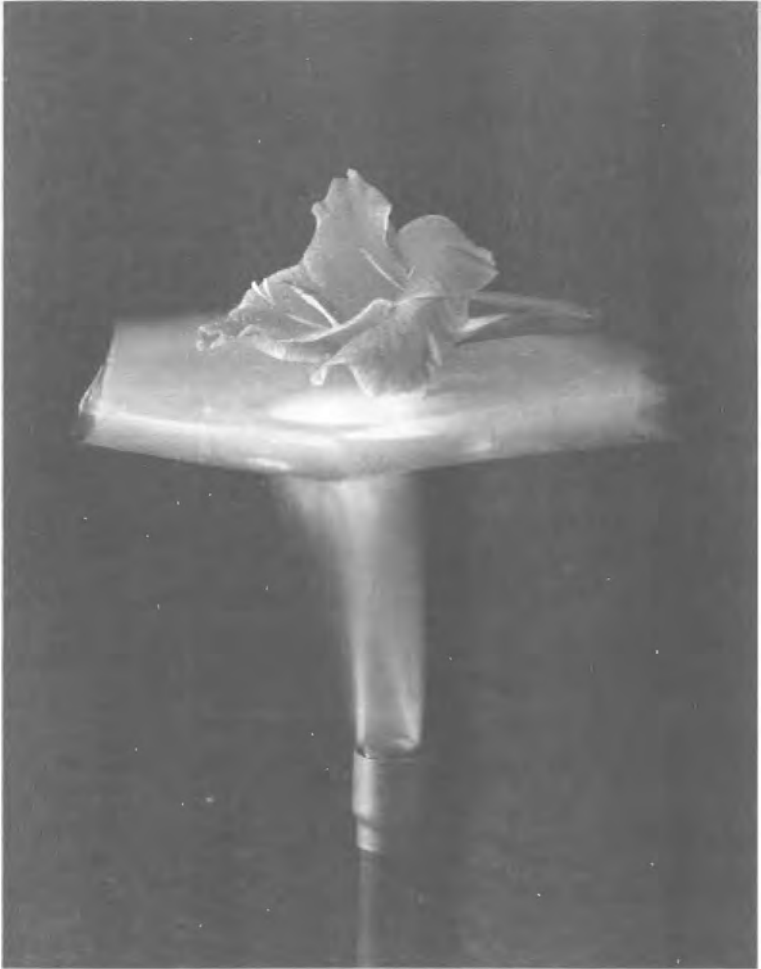
Bir çiçeği Bunsen ocağının yüksek sıcaklığından koruyan silika aerogel.
