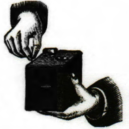
1888'de piyasaya sürülen ilk Kodak fotoğraf makinesi 100 pozluk rulo filmi kullanıyordu. Bu diyagramda kişi örtücüyi açan kordonu çekiyor.
