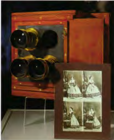
AŞAĞIDA: Özel olarak tasarlanmış fotoğraf makineleri, mercekleri açık kapayarak, bir seferde 4, 6 veya 8 fotoğraf plakası üretebilirdi. Bu metodu icat eden A.A.E. Disdéri, Prenses Buonaparte Gabrielli'ninki (yaklaşık 1862) gibi kartları üretebilmek için, bunun gibi 1854 yapımı bir fotoğraf makinesi kullandı.
