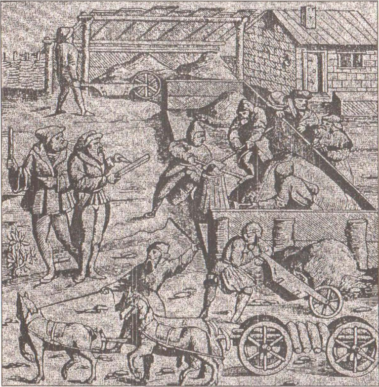
Şekil 13. Temizlenmiş cevherin, el arabası ile maden evine taşınması ve hacmi ölçülerek maden çavuşu (kâtibi) tarafından kaydedilmesi; sağ tarafta duvarın dışında iki maden ağası, en alt tarafta ise pazara mal götürecek olan at arabası [ahşap oyma resim, Sebastian Münster, Cosmographia universalis (Evrensel Kozmografya), Basel, 1544].
