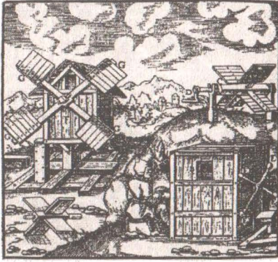
Şekil 29. A- Zemin üzerinde kulübe; B- Bu kulübentn rüzgâr deliği; C ve D- Üzerinde gözler bulunan ahşap kanatlar ve kolu; F- Kırış üzerine yerleştirilmiş ahşap kanatlı kulübe, F- Kanatlar (G. Agricola, De re metallica, 1556). 54
