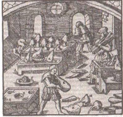
Şekil 31. Maden laboratuvarında imbibiklerle damıtma yoluyla soy metalleri ayırmada kullanılan "ayırma suyu"nun ( HNO_3 ) elde edilmesi: A- Fırın; B- Fırın üzerinde yuvarlak ağız deliği; C- Hava delikleri; D- Fırın ağız; E- Alt hava deliği; F- Tava; G- Balon; H- Külâh; I- Emzik; K- Diğer balonlar; L- Balonun kırılmaması için içine konduğu sepet (G. Agricola, De re metallica , 1556). Aynı resim, Lazarus Ercker'in Beschreibung... (Frankfurt / M., 1598) adlı eserinde de yer almaktadır. Buna göre, bunun için şap ve demir vitriyol tuzlarının ısıtılarak sülfürik asit oluşturulur; bu da tuz karışımında yer alan güherçile ile tepkimeye girerek sonuçta HNO_3 verir. Camsız pencere açıklığındaki adam, olasılıkla içerde oluşan aşırı miktardaki zehirli gazların kaçarak taze hava soluma gereksinimini karşılamaktadır. 61, 62
