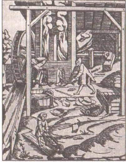
Şekil 14. Arka planda, su dolabıyla çalıştırılan körüklerin görüldüğü kavurma fırınından yoğun kükürt dioksit dumanları çıkıyor; ön planda ise erimiş kurşun, yassı dilimlere dökülüyor (Sebastian Münster, Von dem Elsaß (Alsace Üzerine), 1550 yılı dolaylı).
