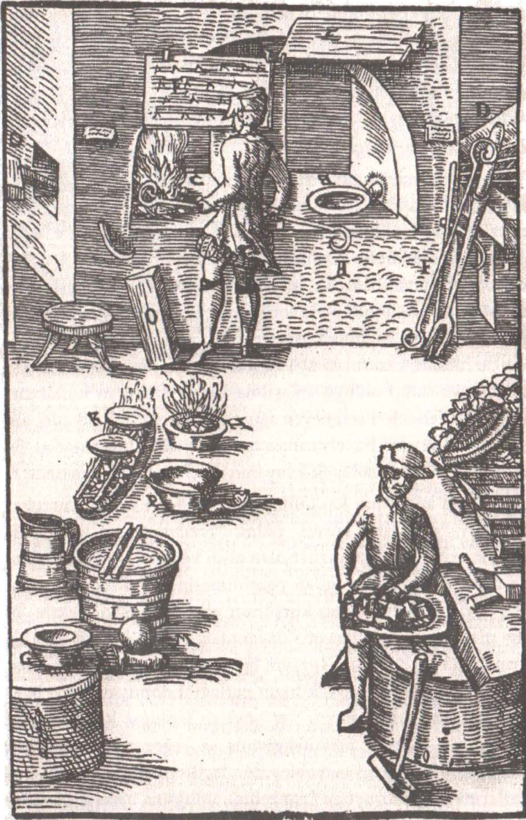
Şekil 44. Ercker'e göre, "dışarlama süreci" ardından erime noktası üzerine kızdırılarak saf gümüş elde etme işlemi (L. Ercker, Beschreibung allerfürnemisten..., Frankfurt / M., 1580). 61
