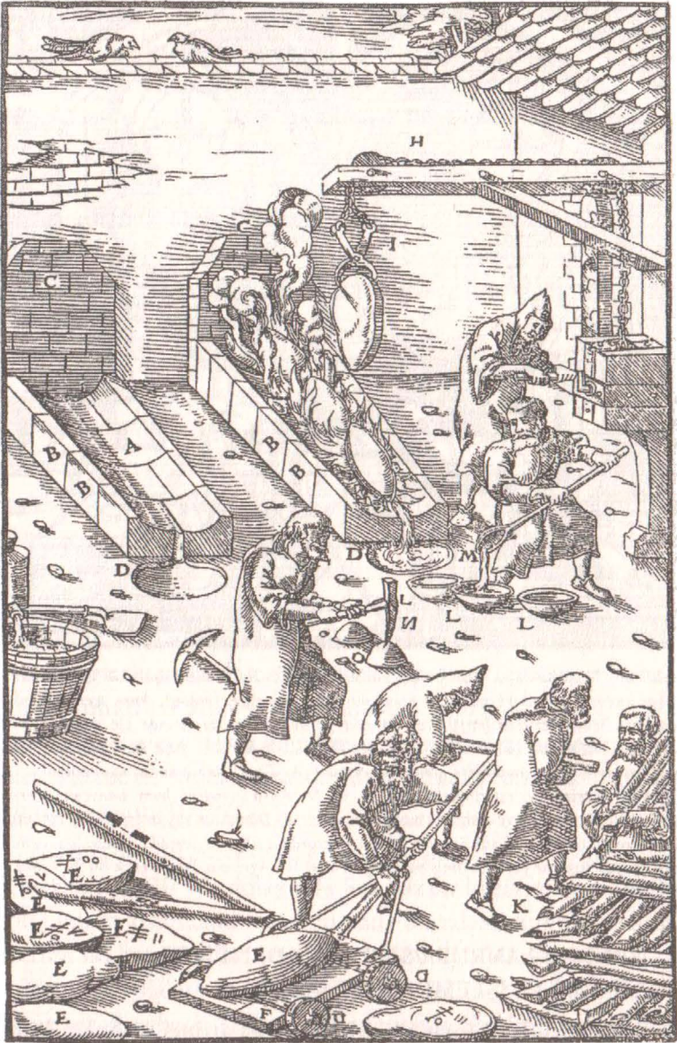
Şekil 35. Kurşun ilavesi eşliğinde akışkan hale getirilerek gümüş ve bakırın ayrılması amacıyla fırınların hazırlanması: Kısaca tutturulmuş kurşun kitleleri, elle çevrilen zincirli kriko aracılığıyla ateşin üzerine doğru hareket ettirilmektedir (G. Agricola, De re metallica, 1556).
