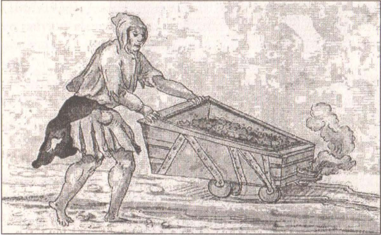
Şekil 38. Tirol maden ocağında el arabası ile cevher nakli (Schwazer Bergbuch, 1556).
