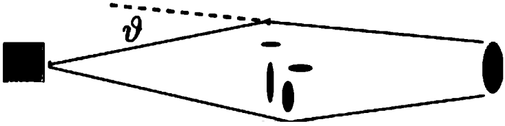
Şekil 8. Sağdaki arka plan gökadasından gelen ışık ışınlarının geometrisini gösteren bir küttelekimsel mercek çizimi; ışınlar merkezdeki gökada kümesinin küttelekimi tarafından bükülür ve soldaki gözlemcinin gözünde gökadanın bir görüntüsü oluşur.
