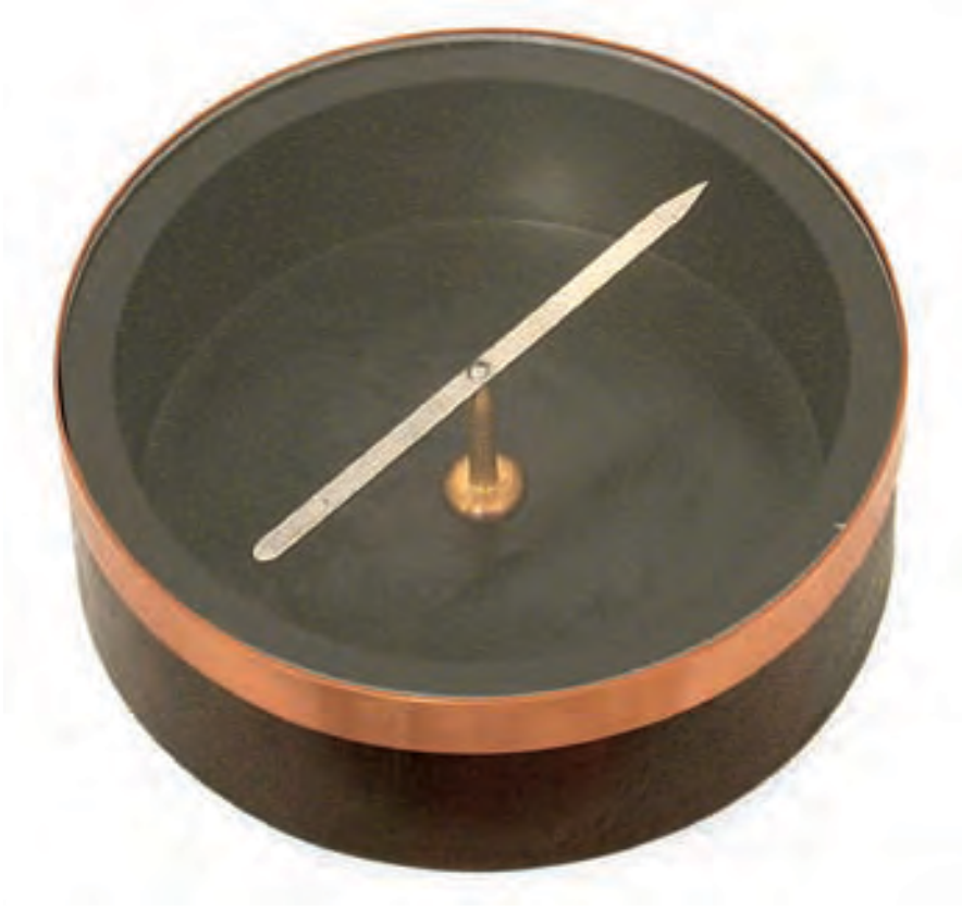
Modelimiz: Silindir sert ağaç, çap: 15 cm. Cam kapak bakır halka ile pekiştirilmiş. Manyetik demir iğne, pirinç mandrel üzerinde hareketli. (Envanter No: C 1.02)
