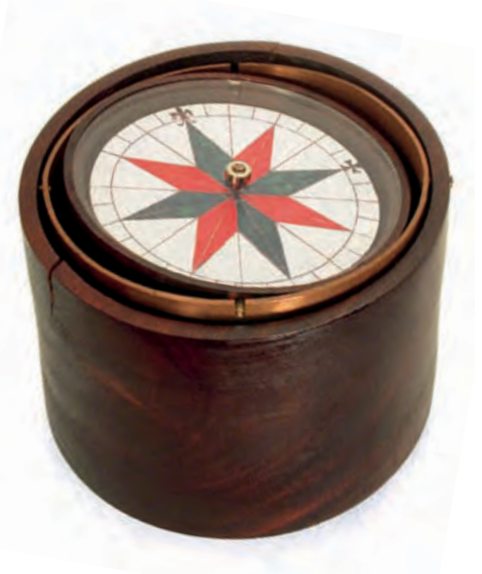
Tornalanmış silindir, sert ağaç. Çap: 24,5 cm. Yükseklik: 17 cm. «Kardano» sistemi süspansiyonu bakır halka aracılığıyla. Disk, balık formunda eğilmiş demir tel ile iki uç arasında, döndürülebilir halde yarım küre formundaki pusula mahfazasına oturtulmuştur. (Envanter No: C 1.09)
