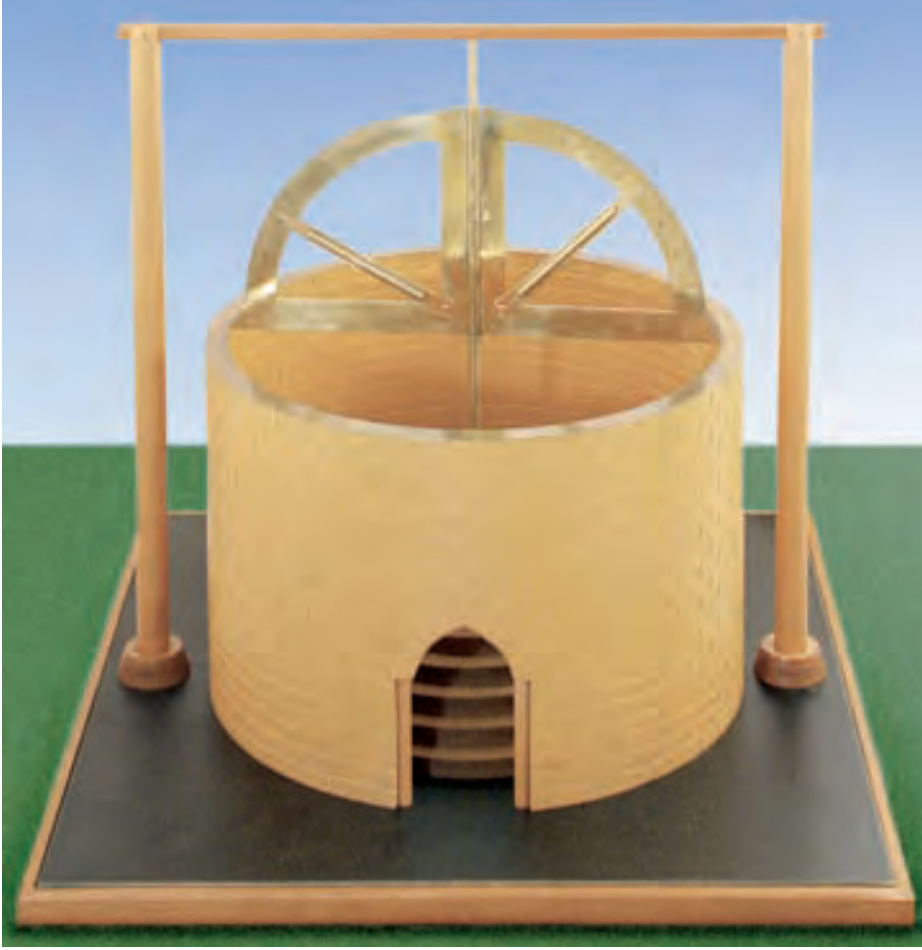
Modelimiz: Ölçek yaklaşık 1:10. Çap 50 cm. Bir eksen çevresinde döndürülebilir iki kadran piringten. Ölçekli ve nişangâhlı hareketli ibreler. (Envanter No: A 4.15)
