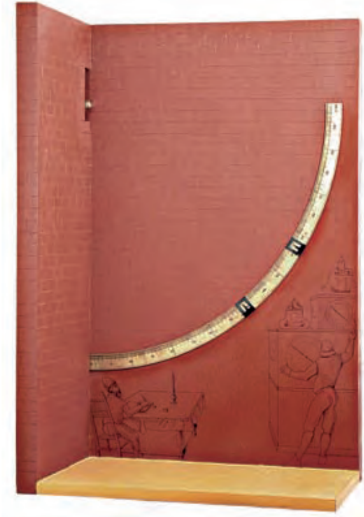
Modelimiz: Ölçek yaklaşık 1:10. Astarlanmış ahşap. 50 x 30 x 80 cm. Kadran pirinçten, derece skalası; 2 nişangâh ve ayarlanabilir nişangâh. (Envanter No: A 4.14)
