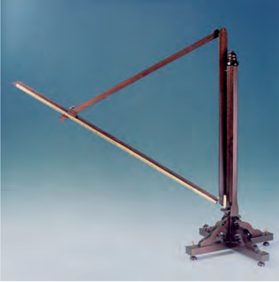
Modelimiz: Ölçek yaklaşık 1:2. Nişangâh uzunluğu 1 m. Eskitilmiş sert ağaç. Uzunluk derece taksimatlı piriç skala. (Envanter No: A 4.06)
