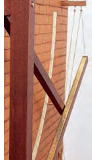
Modelimiz: Ahşap, astarlanmış; mermer kaide. Kadran piringten, asitle derecelendirilmiş; yarıçap: 40 cm. Cetveller tik ağacından iki direk arasında dikey olarak hareket edebilir. Yükseklik 64 cm. Kiriş cetveli üzerinde metrik ölçek bulunmaktadır. (Envanter No: A 4.26)
