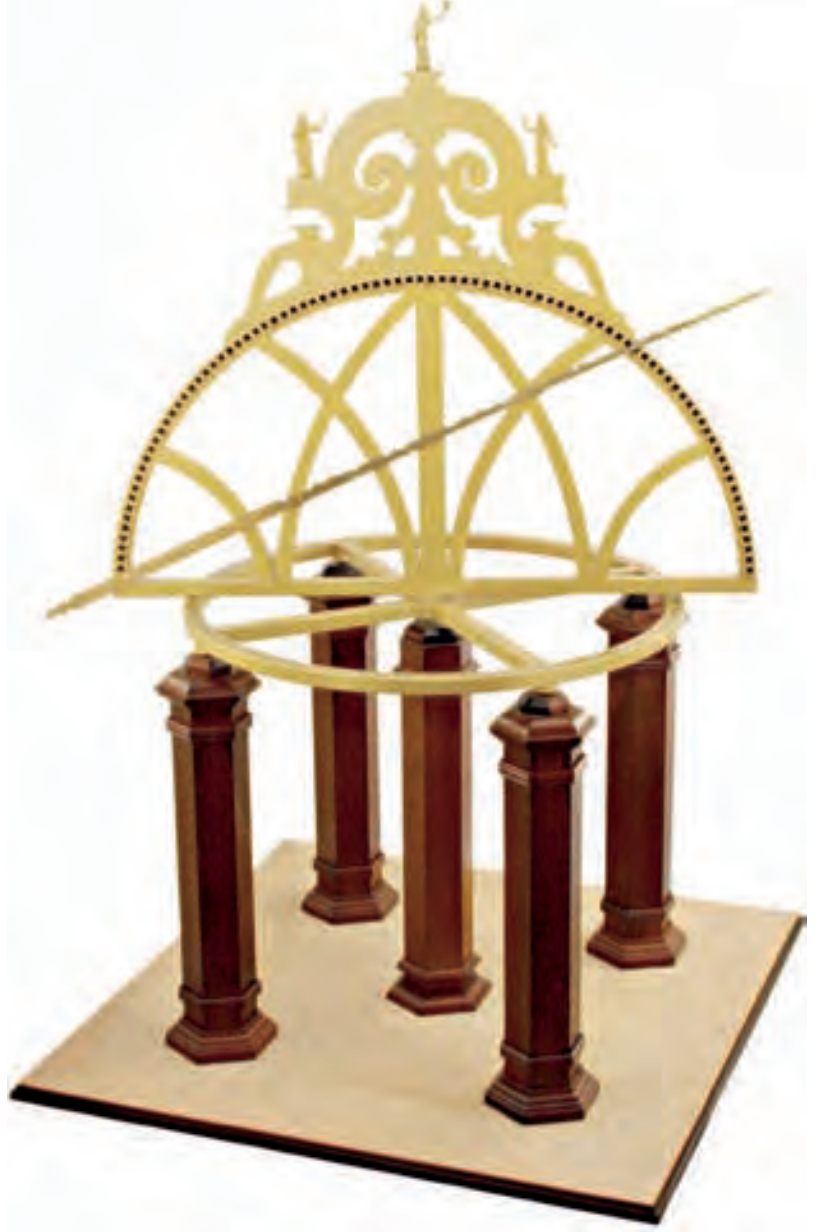
Modelimiz: Ölçek yaklaşık 1:10. Çap 50 cm. Bir yüzü derece taksimatlı oksitlenmiş pirinç başlık. Cetvel, yarım daire yayına alttan döndürülebilecek şekilde yerleştirilmiştir. (Envanter No: A 4.12)
