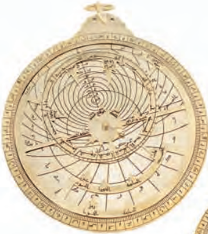
Modelimiz: Piring, asitle işlenmiş. Kulplu ve asma halkalı ana 170 mm. çapında. Bir iç disk. (Envanter No: A 2.25)
