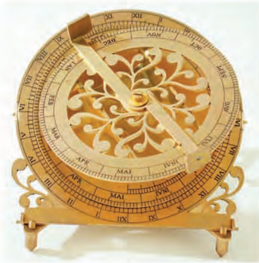
Büyükölük: 10 x 10 cm. Pirinç, hâkkedilmiş. Eğim ayarlana-bilir, nişangâh ve takvim dai-resi eksensel döndürülebilir. (Envanter No: B 2. 11)
