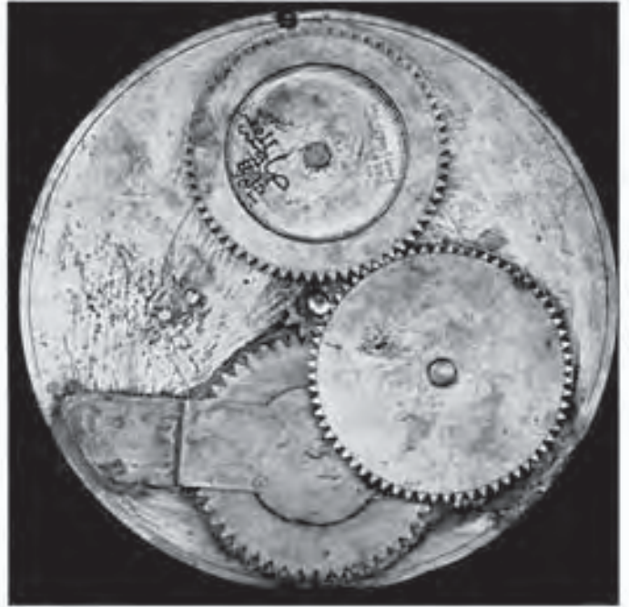
Muḥammed b. Ebî Bekr el-İşfehânî'nin aletinin dişli çark mekanizması
