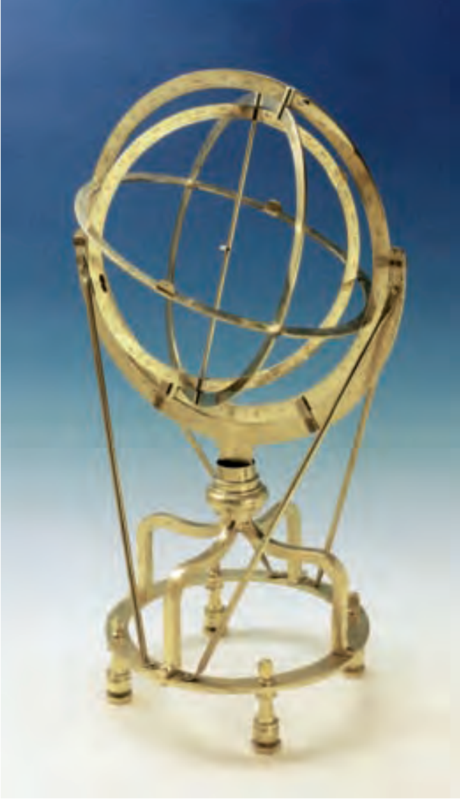
Ölçek 1:4. Çap 50 cm. Piring, hâkkedilmiş. Bütün halkalar her iki tarafı hâkkedilmiş derece taksimatına sahip. (Envanter No: A 4.10)
