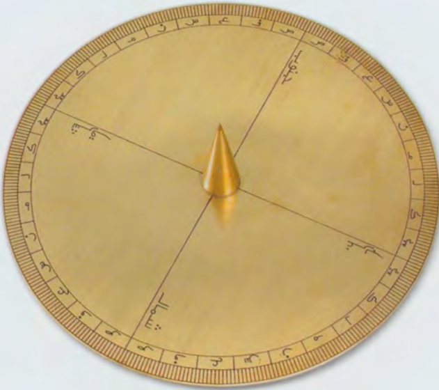
Resim 31: Öylen çizgisini ölçmek için kullanılan ve "Hint dairesi" olarak adlandırılan yöntemi.
