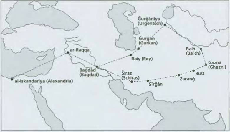
Resim 5: El-Bîrûnî tarafından 11. yüzyılın ilk çeyreğinde arşınlanan mesafeler ve astronomik olarak ölçülen enlemler vasıtasıyla Bağdat ile Gazne arasındaki yaklaşık 60 yerin boylam derecelerini hesaplamaya yönelik yapılan çalışmanın şematik sunumu.
