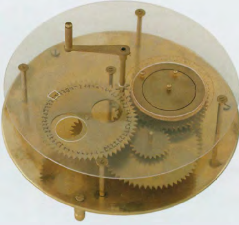
Resim 26: el-Birûnî'nin mekanik güneş-ay takvimi.
