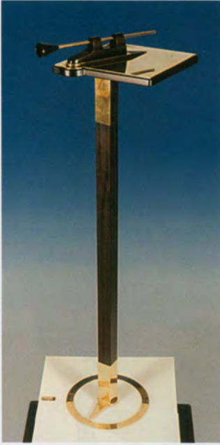
Resim 32: İbn el-Heysem'in (ö. m. 1040 civarı) öylen çizgisini bulma yöntemi.
