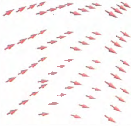
Maxwell'in elektromanyetizma teorisiyle ortaya çıkardığı temel bir matematiksel kavram olan alan. Oklar alanın kuvvetini ve yönünü; gri çizgilerden oluşan sistem ise uzaydaki her noktanın koordinatlarını gösteriyor. Bkz. s. 45.
