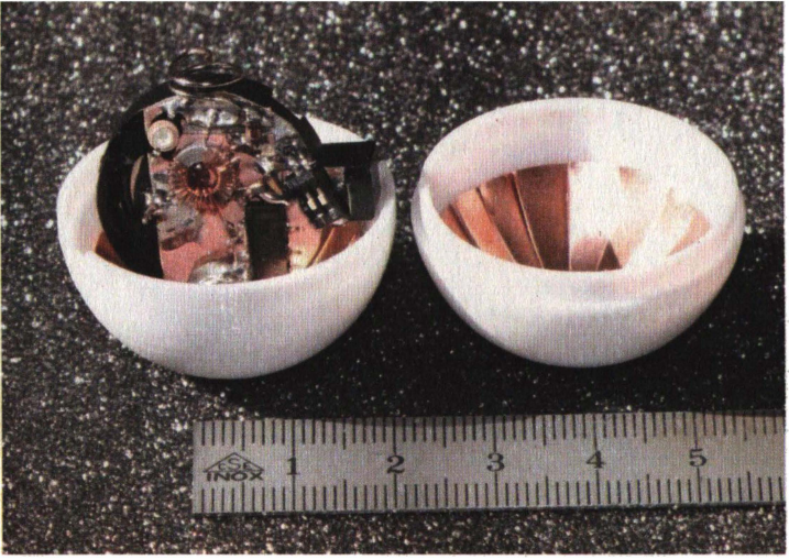
Tıkanmaları denetlemek üzere LHC'nin huzme borularından içeri gönderilen, radyo vericileriyle donanmış "pinpon toplarından" biri.
