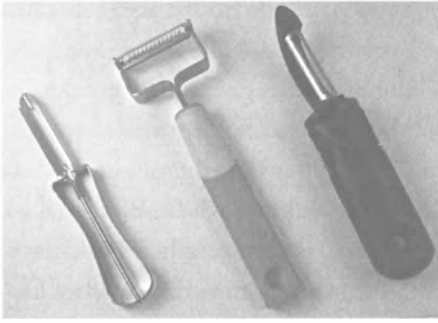
Şekil 6.3. Üç Sebze Soyacağı. Geleneksel metal sebze soyacağı solda görülüyor: Ucuz ama kullanması rahatsız. Endüstride devrim yaratan OXO marka soyacak, sağda görülüyor. Bu devrimin sonucu, İsviçreli Kuhn Rikon adlı şirketin ürettiği soyacak ortada görülüyor: Renkli ve rahat.
