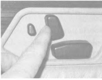
Şekil 1.7. İyi Eşleştirme: Otomobil Koltuğu Ayar Düğmesi. Bu, doğal eşleştirmenin mükemmel bir örneği. Denetim düğmesi koltuk biçiminde: Eşleştirme gayet net. Koltuğun ön tarafını yükseltmek için düğmenin ön tarafını iterek yükseltin. Koltuk sırtını geriye yaslamak için düğmeyi geriye doğru çekin. Aynı ilke sıradan birçok nesneye uygulanabilir. Örnekteki bu düğme, Mercedes Benz'den; ama bu tür eşleştirme şimdi birçok otomobil şirketi tarafından kullanılıyor. (Fotoğraf yazar tarafından çekilmiştir.)
