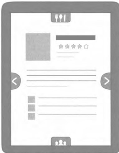
Şekil 1.6. Dokunmalı Bir Ekrandaki İmleyenler. Ok ve simgeler imleyenlerdir: Bu lokanta rehberinde izin verilen işlemlerin sinyallerini verir. Sola ya da sağa çekildiğinde yeni lokanta önerileri gelir. Yukarı çekildiğinde, gösterilen lokantanın mönüsü görülür; aşağı çekildiğindeyse o lokantayı öneren arkadaşlar.
