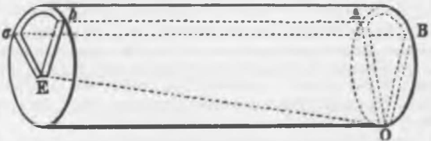
Kaleydoskop içindeki aynaların konumu.
