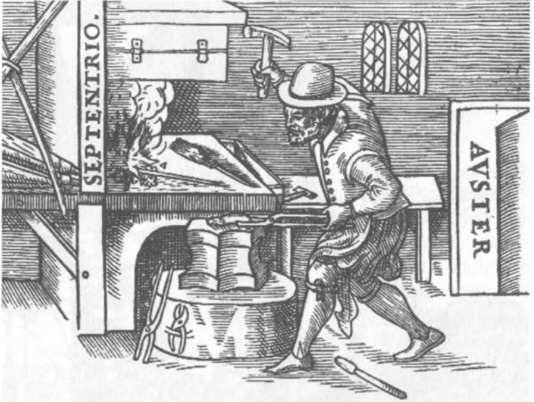
ŞEKİL 42. Demirin dövülerek mıknatıslanması: Gilbert, akkor halinde kızdırılan demir parçasının, kendi mıknatıslığını yitirdiğini biliyordu. Ama demir soğurken, kuzey-güney (Septentrio-Auster) yönünde yerleştirilip çekiçe dövüldüğünde mıknatıslığını yeniden kazanabiliyordu (W. Gilbert, De magnete..., 1600). 13,71,74
