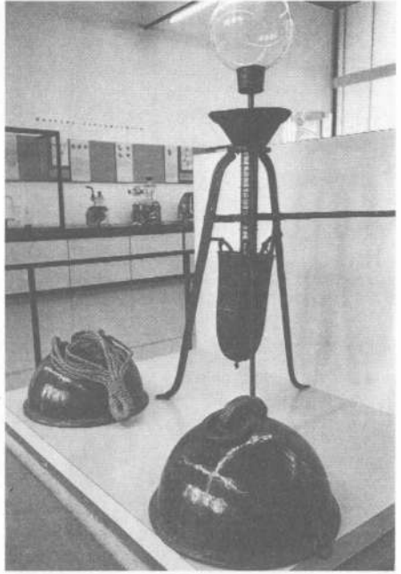
ŞEKİL 105. Otto von Guericke'nin 1663'te yaptığı ve hava basıncının gücünü sergilediği ünlü Magdeburg yarımküreleri ve hava pompasının özgün gereçleri (Deutsches Museum, Münih).
