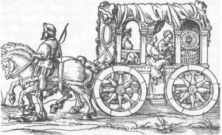
ŞEKİL 126. Yolölçerli araba [ahşap oyma; Vitruvius, De architectura libri X (Mimarlık Üzerine On Kitap) (İÖ 25), Rivius baskısı, 1547]. 131
