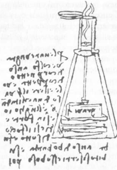
ŞEKİL 118. Leonardo da Vinci'nin barutlu atmosferik makinesi (1508 dolayı). Resme eşlik eden yazıda, söz konusu makine için "Per levare un grave col foco" ("Ağır bir cismi, ateş yardımıyla kaldırmak için") denmektedir. 37
