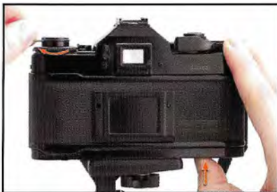
Filmi geri sarmak için önce "geri sarma kilidi"ne basmalı, sonra da "geri sarma kolu"nu ok yönünde çevirmelisiniz.
