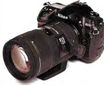
105 mm'lik bir makro objektif, odak çarpanı 1,5x olan bir DSLR üzerinde 157,5 mm eşdeğeri bir odak uzunluğuna sahip olur, ama alan derinliği aynı kalır.
