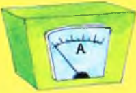
Ampermetre akım ölçer.
