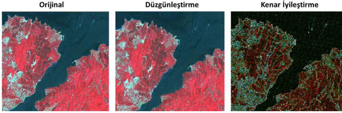
Şekil 11.5. Orijinal ve filtreleme uygulanmış uydu görüntüsü.
