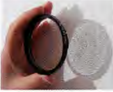
Yumuşak odaklı filtrenin yüzeyindeki küçük kalıplanmış mercekler, gölgesinde görülebiliyor.
