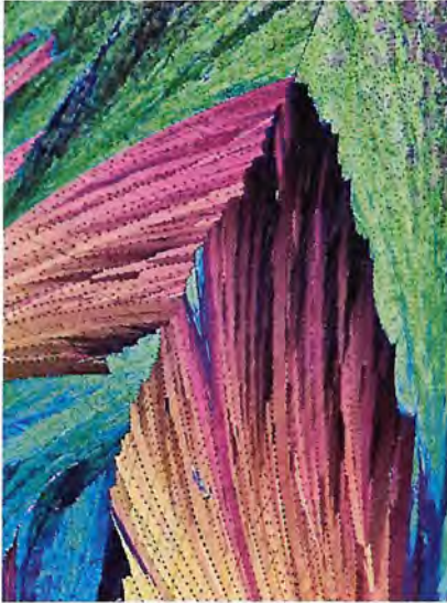
Burada görülen, polarize ışıkta 40 kat büyütülmüş parasetamol kristalleridir, görüntü Brunel BMS üç okülerli zumlu stereomikroskopun üzerindeki Kodak Professional DSC 520 (Canon mount) ile alınmıştır.
