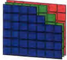
Foveon görüntü sensörünün üç katmanlı yapısı.
