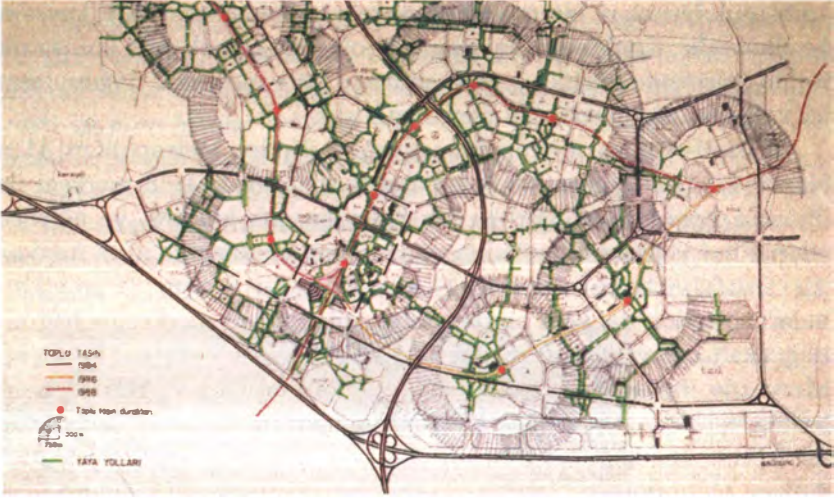
Şekil 8: Toplulaşım Sistemi, merkezler, alt merkezler, yaya dolaşımı ve yürünebilirlik alanları (T.Ateş ve planlama ekibi).
