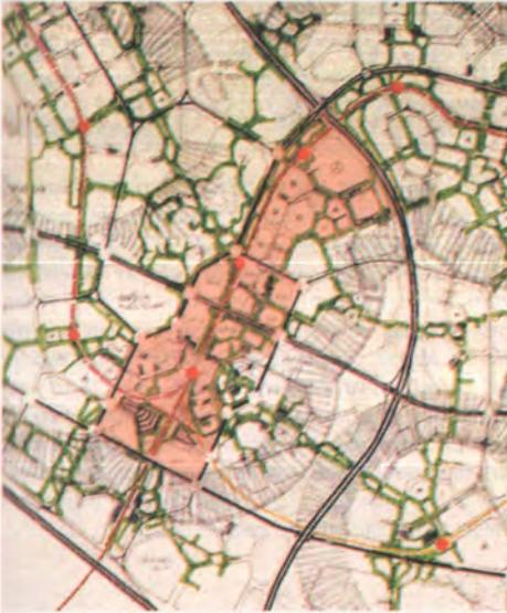
Şekil 17: T.Ateş ve planlama ekibinin Batıkent merkez bölgesi 1/5000 ölçekli plan şematik gösterim. Merkez, raylı toplu taşıma hattı ve ana yaya yolundan oluşan omurga üzerinde biçimlenmiştir. Taşıt yolları merkezi dışarıdan çevrelemektedir. Merkez kullanımları bir omurga üzerinde yaya sürekliliği ile güçlendirilmektedir. Toplu taşıma durakları, merkezi yerleri tanımlayan önemli öğelerdir.
