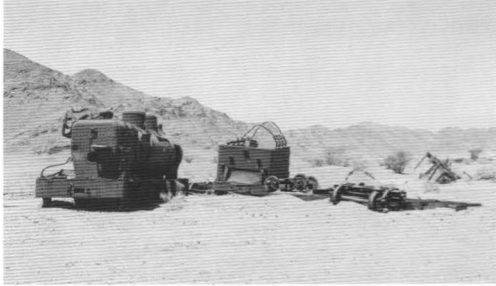
Hicaz, Vayban istasyonunun g neyinde enkaza d nm   bir tren, Mart 2005. Taban plakası ve ocaktaki hasar (sağda), muhtemelen bir madenden kaynaklanmıştı.
