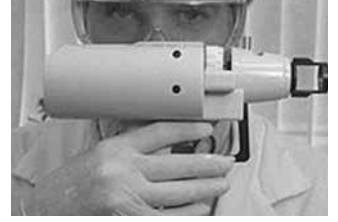
Seçilen genler 22 kalibrelik bu tabancalar ile bitkilere naklediliyor.
