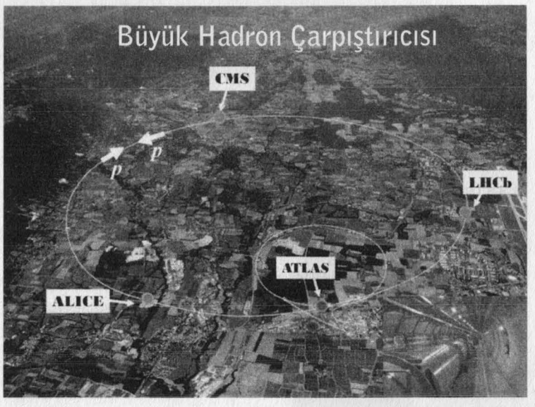
Şekil 13.4. ATLAS deneyi İsviçre'nin Cenevre kentindeki CERN'de bulunan Büyük Hadron Çarpıştırıcısı'nda yapıldı. ATLAS büyük patlamadan sonraki saniyenin minik bir biriminde son kez görülen enerjilerin benzerlerini üreten çarpışmaların ürünlerini saptayan altı dedektörden biridir. Büyük Hadron Çarpıştırıcısı Standart Model'deki bütün parçacıkların kütlelerini belirlemek üzere öne sürülmüş Higgs bozonunu saptamak amacıyla tasarlanmıştır.
